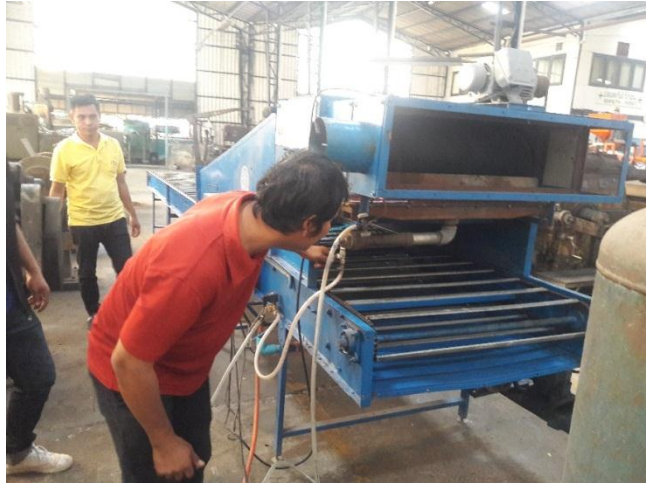
ภาพที่ 5.7 อุปกรณ์ให้ความร้อนแบบรังสีอินฟราเรดผ่านแหล่งความร้อนจากแก๊ส LPG
