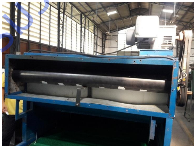
ภาพที่ 5.9 ติดตั้งอุปกรณ์ให้ความร้อนแบบฮีเตอร์ไฟฟ้าภายในตัวเครื่อง
