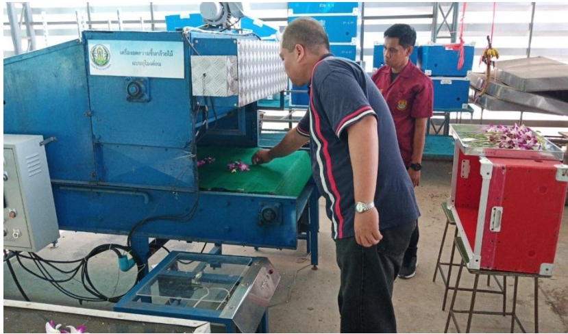
ภาพที่ 5.16 ทดสอบการลดความชื้นกล้วยไม้ด้วยเครื่องแบบอูโมงค์ลมและชุดตรวจสอบกล้วยไม้
