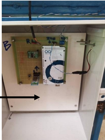
ภาพที่ 5.19 อุปกรณ์ส่งสัญญาณ wireless ในชุดชั่งน้ำหนักหลังลดความชื้นกล้วยไม้
