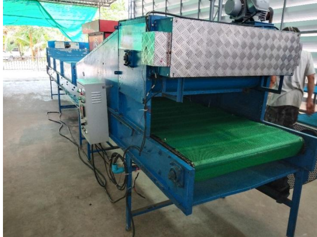
ภาพที่ 5.13 เครื่องลดความชื้นกล้วยไม้แบบอุโมงค์ลมพร้อมสำหรับการทดสอบใช้งานจริง
