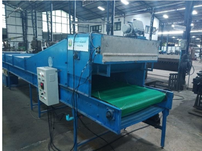
ภาพที่ 5.10 ตู้ควบคุมการทำงานของเครื่องลดความชื้นกล้วยไม้แบบอูโมงค์ลม
