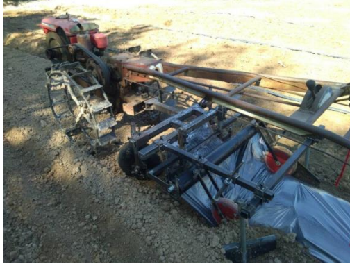
ภาพที่ 1.8 การทดสอบ เครื่องปูพลาสติกต้นแบบที่พัฒนาแล้ว
