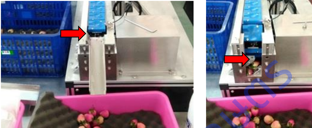
ภาพที่ 4.17 ผลสตรอเบอร์รี่หลุดลงในช่องว่างระหว่างสายพานตัดแยกกับรางทางลงผลสตรอเบอร์รี่
