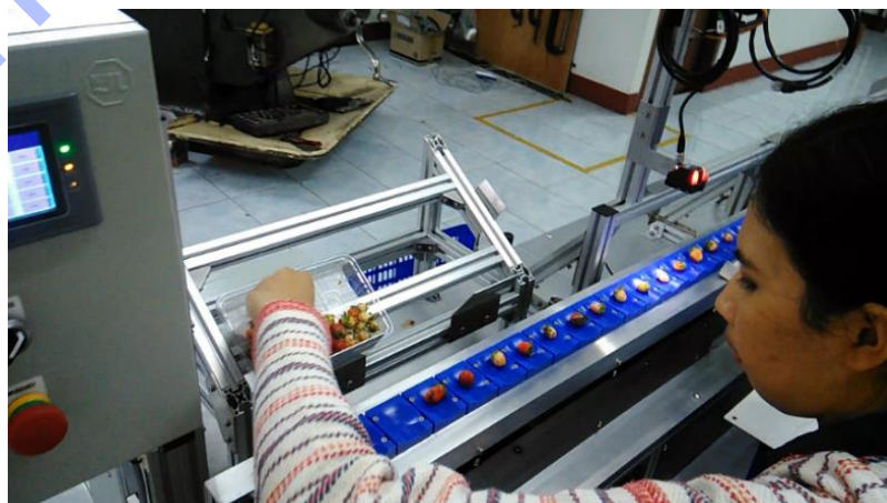
ภาพที่ 4.13 ทดสอบการทำงานของโปรแกรมคัดแยกสีผลสตรอเบอร์รี่
