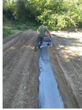
ภาพที่ 1.8 การทดสอบ เครื่องปูพลาสติกต้นแบบที่พัฒนาแล้ว
