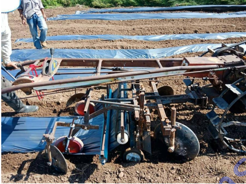
ภาพที่ 1.3 ต้นแบบเครื่องปูพลาสติกติดรถไถเดินตามสำหรับสตรอเบอร์รี่
