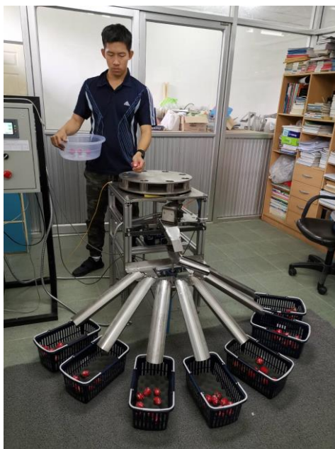
ภาพที่ 3.28 ทดสอบเครื่องต้นแบบเพื่อการคัดแยกขนาดผลโดยน้ำหนัก 7 เกรด
