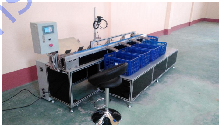
ภาพที่ 4.16 ต้นแบบเครื่องคัดแยกสีผลสตรอเบอร์รี่โดยใช้เทคนิค Image Processing
