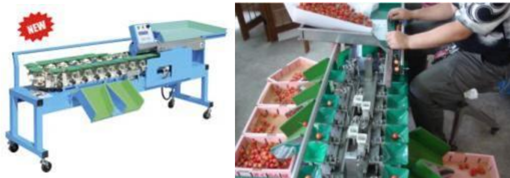
ภาพที่ 3.2 การคัตน้ำหนักรูปแบบใช้หลักการถ่วงน้ำหนัก
