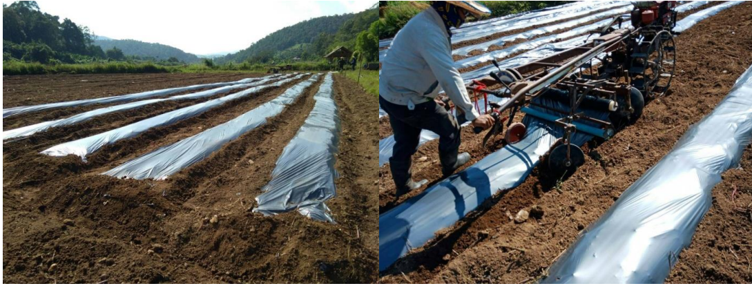
ภาพที่ 1.5 แปลงที่ทดสอบปูพลาสติกด้วยเครื่องต้นแบบ
