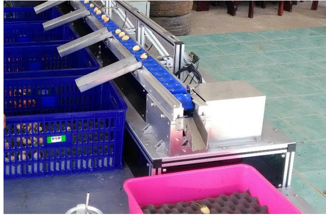
ภาพที่ 4.19 ปรับปรุงรางท้ายสายพานคัดแยกเพื่อไม่ให้ผลสตรอเบอร์รี่หล่นลงในช่องว่าง
