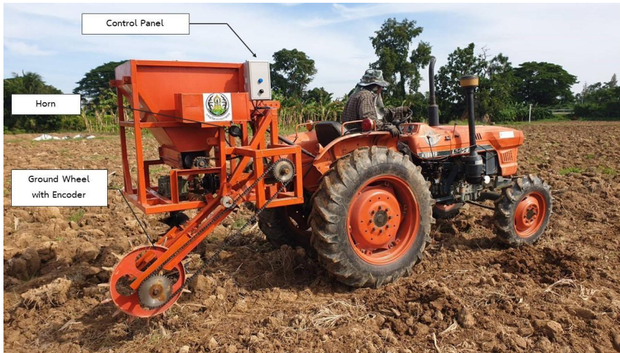
ภาพที่ 5.3 ตำแหน่งการติดตั้งตู้ควบคุมและเอ็นโค้ดเดอร์ (Rotary Encoder)
