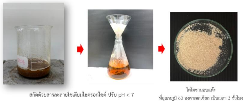
ภาพที่ 21 การสกัดสารไคโตซานจากเปลือกกุ้ง
