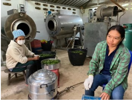
3.อบไอน้ำด้วยเครื่องอบไอน้ำหรือหม้อนึ่งที่ 100 องศาเซลเซียส นาน 2 นาที
