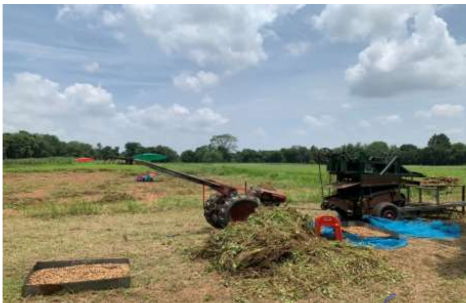
ภาพที่ 22 เครื่องปลิดฝักข้าวลิสงแบบติดรถไถเดินตามแหล่งปลูกในภาคตะวันออกเฉียงเหนือตอนบน
