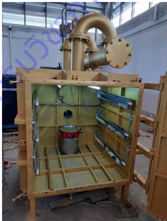
ภาพที่ 37 เครื่องกวนระเหยน้ำในภาวะสุญญากาศแบบควบคุมการทำงานอัตโนมัติสำหรับทำน้ำอ้อยเข้มข้นและน้ำเชื่อม
