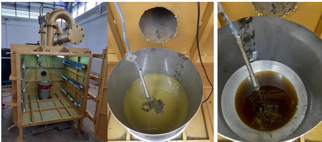
ภาพที่ 11 การทดสอบต้มระเหยน้ำอ้อยภายใต้ห้องลดแรงดันอากาศที่สร้างขึ้น
