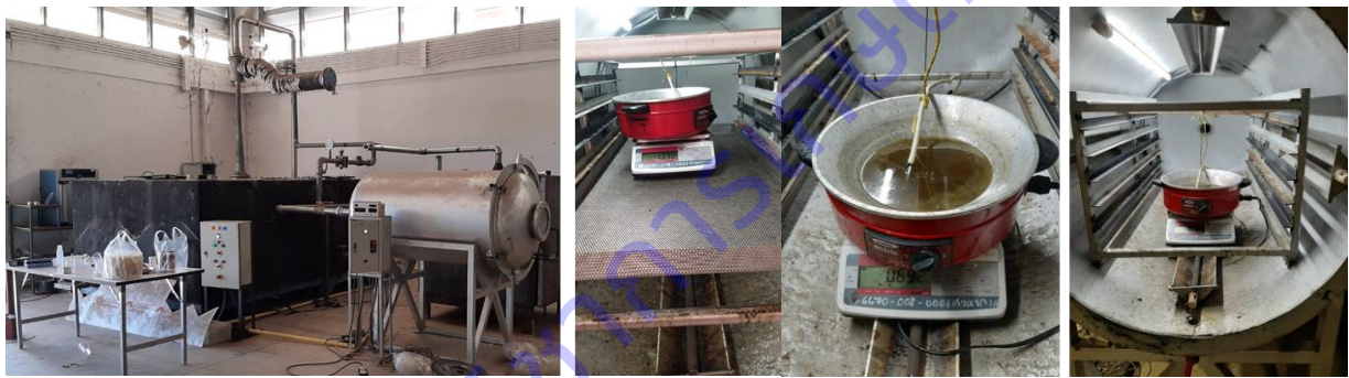
ภาพที่ 7 การสร้างอุปกรณ์ต้นแบบในการทดสอบต้มระเหยน้ำอ้อย
