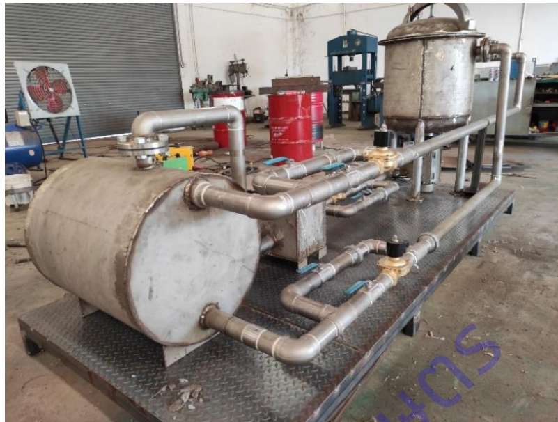
ภาพที่ 36 เครื่องทอดสุญญากาศอัตโนมัติโดยเทคนิคการควบคุมแบบสมองกลฝังตัว
