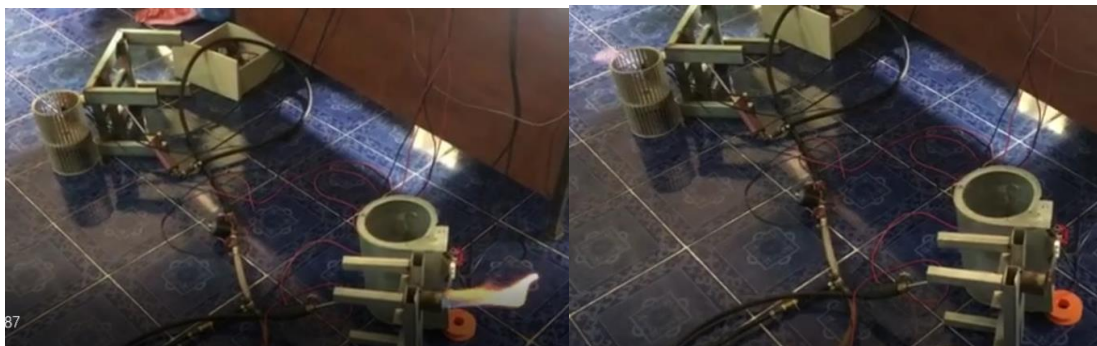
ภาพที่ 29 ทดสอบวงจรควบคุมการสลับทิศทางหมุนของมอเตอร์ และการสปาร์คจุดหัวฟืนไฟ (BURNER)
