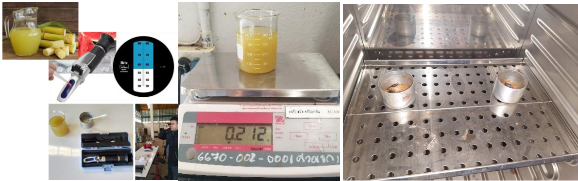
ภาพที่ 6 วัดค่าความหวานของน้ำอ้อย ด้วยเครื่องวัด Brix refractometer หาปริมาณต่อน้ำหนักของน้ำอ้อยที่ % Brix ที่วัดได้ (23 % Brix)
