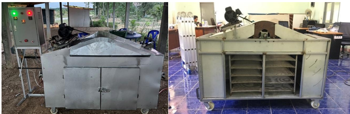
ภาพที่ 38 เครื่องอบลมร้อนแบบถาดอัจฉริยะสำหรับการลดความชื้นผลิตผลเกษตร
