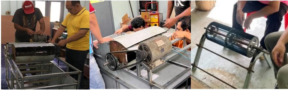
ภาพที่ 27 ถ่วงใบพัดลมแบบ Static Balancing (ซ้าย) การติดตั้งและทดสอบใบพัด (กลาง) ทดสอบล้นปิดเปิด บังคับทิศทางลม (ขวา)
